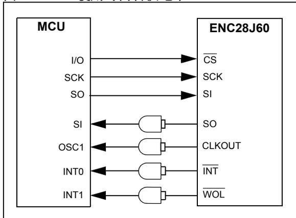
图 2-6: 使用三态缓冲器转换电平
