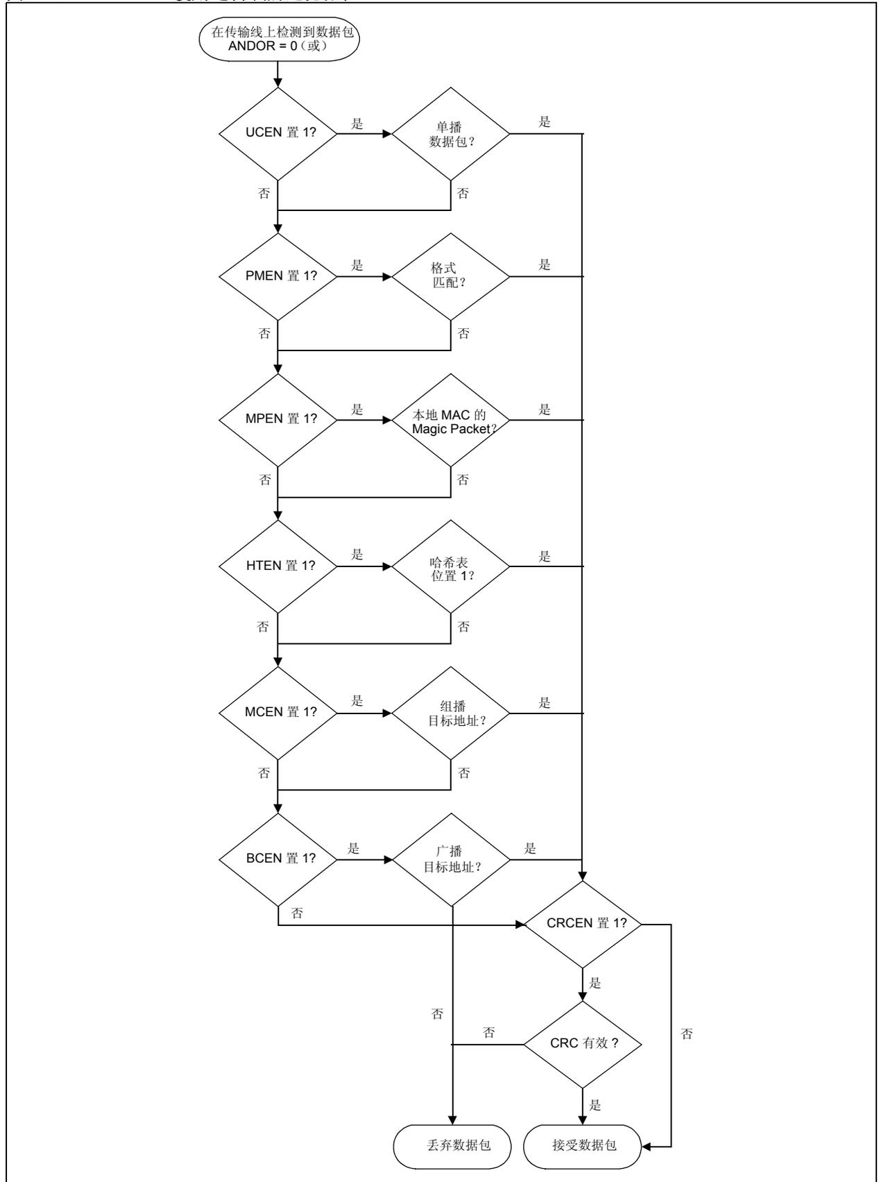
图 8-2: 使用逻辑与的过滤流程
