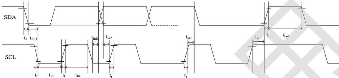
测试条件 1: 1.8V 通讯接口, 400Kbps 通讯速度, 上拉电阻 2K
