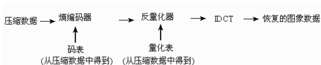
图 9.4 解码器流程
